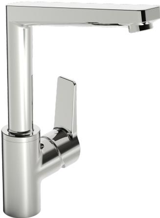
Смеситель для кухни с боковым управлением, высоким поворотным изливом и цельной рукояткой. Излив може быть зафиксирован, а также, угол его поворота может быть неограничен (360°). Встроенная опция ограничения расхода и температуры воды.
