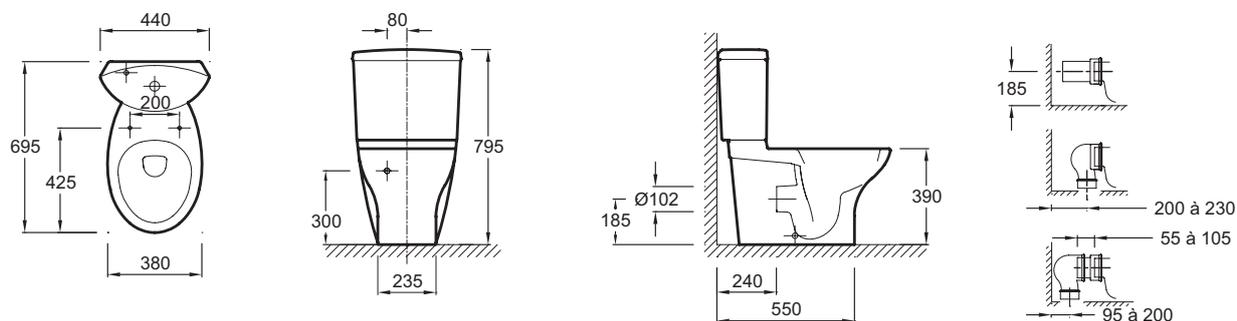
Спецификация продукта: Унитаз «vario» на 6 л. 19077. Коллекция: PRESQU'ILE. Размеры (см): 69,50 x 38 см. Вес: 28,4 кг. Материал: Керамика. Расход воды: Стандарт: 3/6 л. Высота: Стандартные. В комплекте: крышка-сиденье с механизмом "плавное опускание" из термодюра E70016, на металлических шарнирах.
