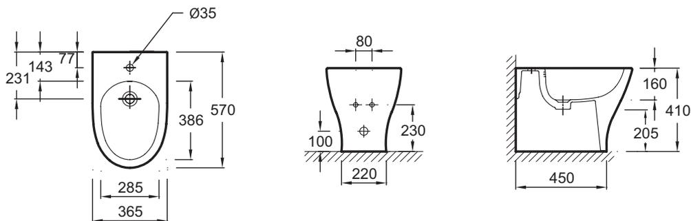
Спецификация продукта: Напольное биде 57 x 36,5 см, устанавливается вплотную к стене. E4798. Коллекция: ODEON UP. Размеры (см): 57 x 36,50 см. Вес: 19,8 кг. Материал: Керамика. 1 выпускное отверстие.
