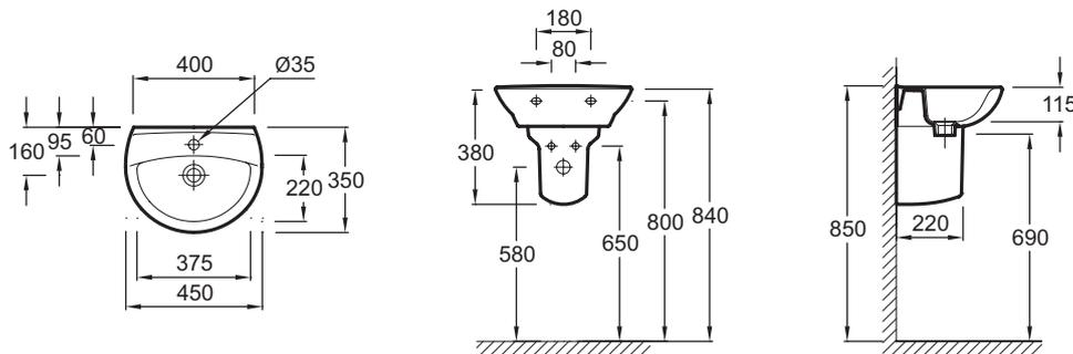
Спецификация продукта: Рукомойник 45 x 35 см без переливного отверстия. E4144. Коллекция: BRIVE. Размеры (см): 45 x 35 см. Вес: 8 кг. Материал: Керамика. Тип установки: Подвесные. Разметка сверления отверстия для смесителя: С 1 отверстием для смесителя.
