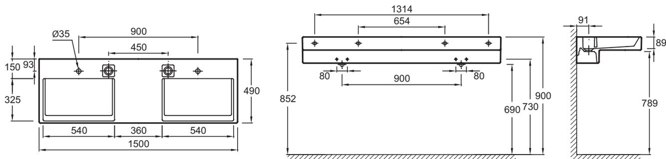
Спецификация продукта: Двойная подвесная раковина-столешница 150 x 49 см. EXA112. Коллекция: TERRACE. Размеры (см): 150 x 49 см. Вес: 49,5 кг. Материал: Керамика. Тип установки: Подвесные или могут быть установлены вместе с мебелью. Разметка сверления отверстия для смесителя: По одному отверстию справа и слева, 2 размечено.
