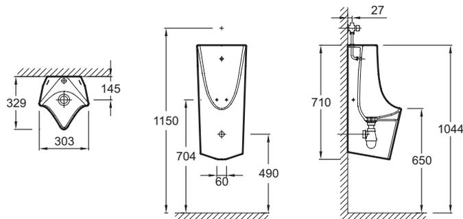
Спецификация продукта: Писсуар 33 x 71 x 30 см, со встроенной верхней подводкой и сливной трубой. EZA122. Коллекция: STRUKTURA. Размеры (см): 30 x 33 см. Встроенная подводка и сливная труба, полный комплект аксессуаров (крепежные скобы, распылитель воды, шланг, слив с фильтром и полипропиленовый сифон).
