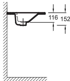
Спецификация продукта: Раковина 61 см. EXS112. Коллекция: OLA. Размеры (см): 61 x 46 см. Вес: 11,8 кг. Разметка сверления отверстия для смесителя: С 1 отверстием для смесителя.
