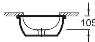
Спецификация продукта: Встраиваемая раковина 44,2 x 36,2 см без переливного отверстия. EYI002. Коллекция: VOX. Размеры (см): 44 x 36 см. Вес: 9,9 кг. В комплекте: крепежи. Без переливного отверстия.
