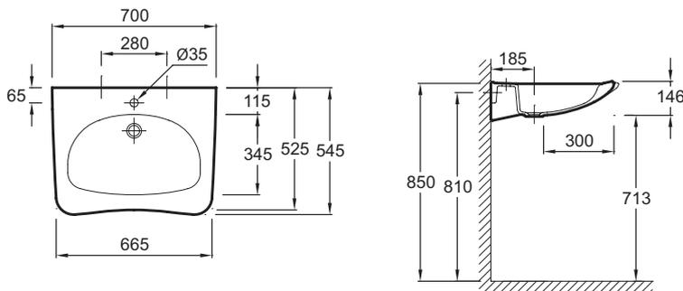
Спецификация продукта: Подвесная раковина 70 x 54,5 см. E1980. Коллекция: HANDILAV. Размеры (см): 70 x 54,50 см. Вес: 19 кг. Разметка сверления отверстия для смесителя: С 1 отверстием для смесителя. Без переливного отверстия.
