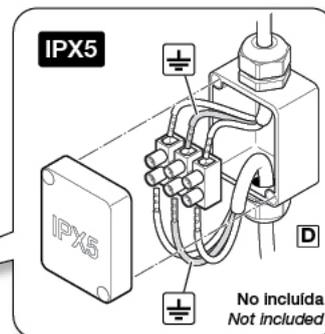
**ES** **A** La instalación eléctrica debe protegerse mediante un interruptor diferencial de  $I_{\Delta n}$  0,03A y 25A de potencia y de un interruptor magnetotérmico de 20A, situado fuera de los volúmenes del cuarto de baño.
