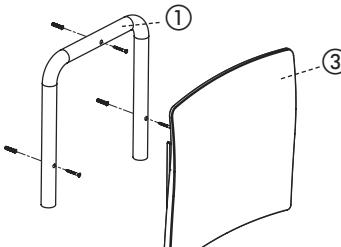
L'installation doit être réalisée par un(e) professionnel(le) en respectant les réglementations en vigueur, prescriptions des bureaux d'études et règles de l'art. Les vis fournies sont destinées à des murs béton. Le choix des chevilles et vis doit être adapté au support mural qui devra être renforcé si nécessaire.
