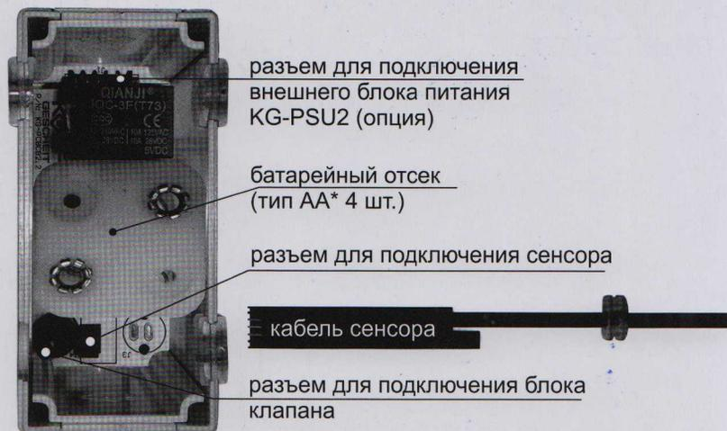
разъем для подключения внешнего блока питания KG-PSU2 (опция)
