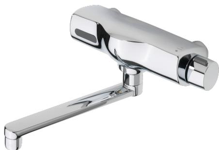
Бесконтактный смеситель для умывальника с поворотным изливом, аэратором, ограничителем расхода воды (6 л/мин) и рукояткой регулировки температуры. Работает от батарейки 6 В. Рукоятка регулировки температуры имеет встроенный ограничитель, для получения более горячей воды необходимо нажать кнопку на рукоятке. Смеситель оснащен грязевыми фильтрами и обратными клапанами. Эксцентриковые соединители и розетки не входят в комплект.
