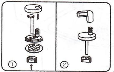
Установить крепеж на унитаз. Закрутите гайки, но не до конца.
