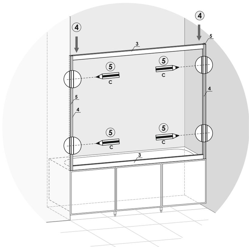
6. Просверлите стены и установочный профиль (рис.6).
