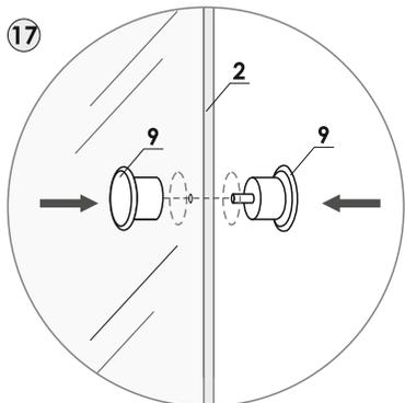
18. Установите магнитный профиль на подвижные стекла в место смыкания (рис.18).
