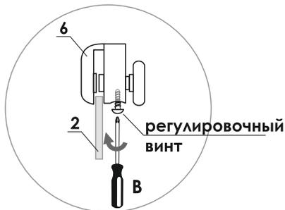
20. По разметке на верхних направляющих просверлите отверстия диаметром 2-2,5 мм и установите демпферы роликов, используя саморезы 3,5x9,5 (полусфера). Закройте отверстия декоративными заглушками (рис.20).
