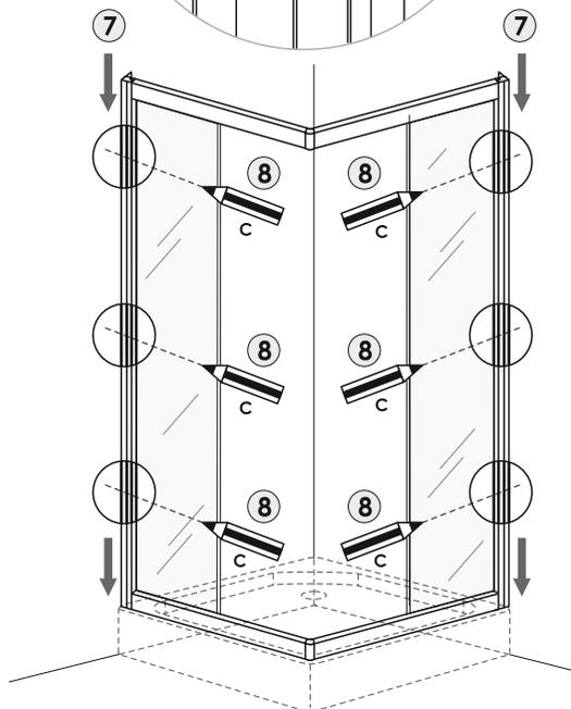
9. Просверлите стены и установочный профиль (рис. 9).
