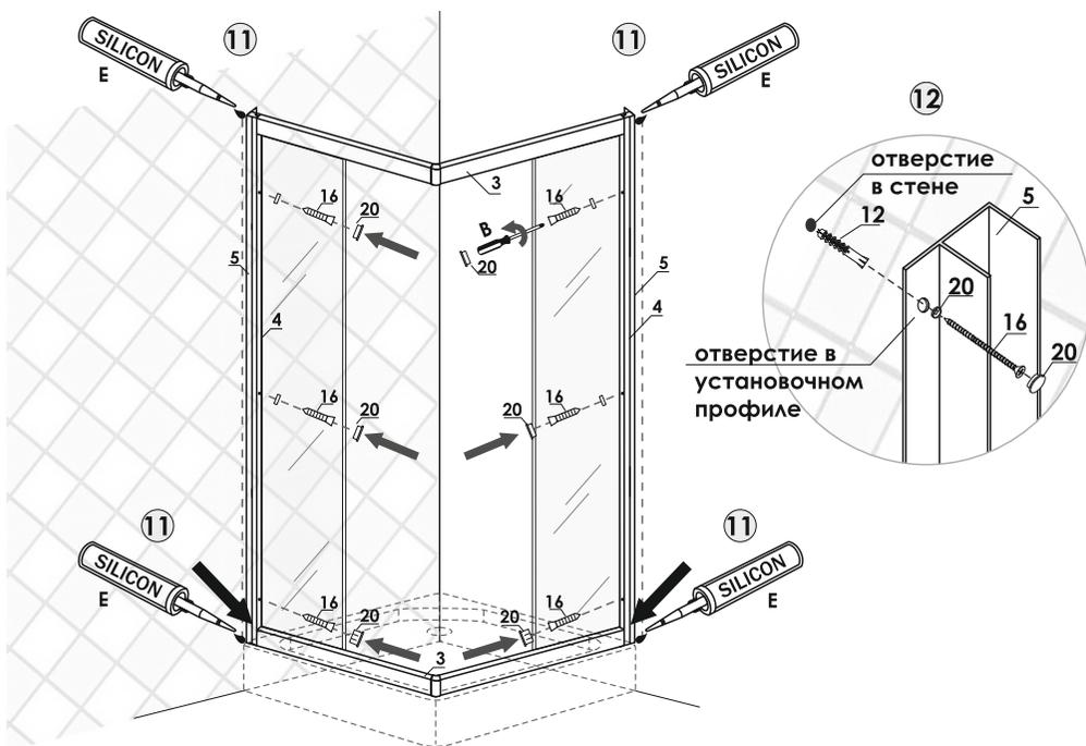
13. Закрепите между собой собранную раму и установочный профиль с внутренней стороны ширмы шурупами 3,9x13. Используйте декоративные заглушки (рис. 13).
