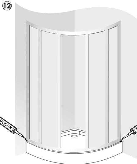
11. Нанесите герметик на душевой поддон в месте соприкосновения с нижней дугой каркаса, установите ограждение, заправив в наружные установочные профили (п. 3.1). См. рис. 12
