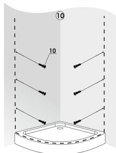
10. Нанесите герметик в паз наружного установочного профиля (п.3.1) и в места соприкосновения профиля к стене, закрепите его к стене шурупами 4x70 (п.12). См. рис. 11.
