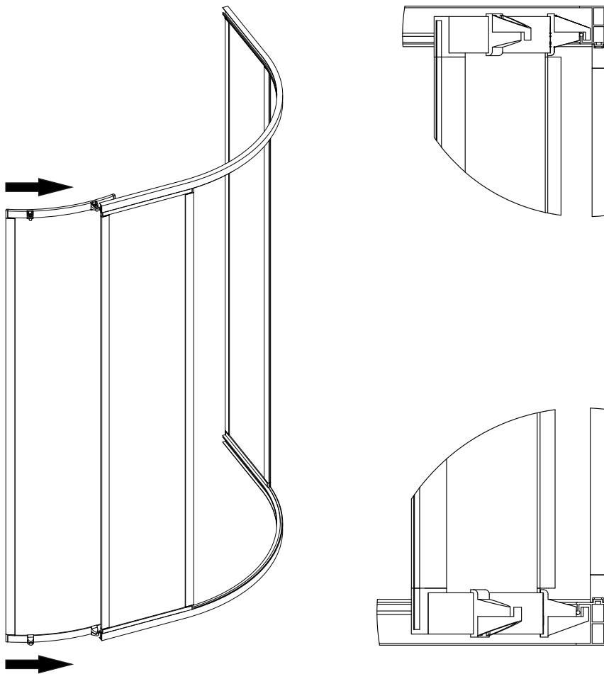
6. К дугам каркаса (п.4) шурупами 3,5x9,5 со сверлом полусфера (п.13) прикрутите демпферы (п.11), согласно нанесенной разметке (рис. 6).
