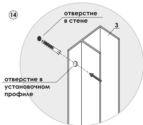
15. Зафиксируйте всю конструкцию к стенам (рис.15).
