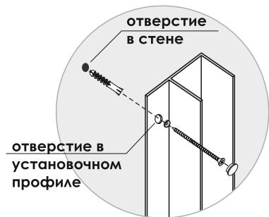
16. Закончите сборку основной ширмы, согласно инструкции. Отрегулируйте расположение ширм в установочных профилях и зафиксируйте их, используя шурупы 3,9x13 со сверлом и декоративные заглушки (рис.16).
