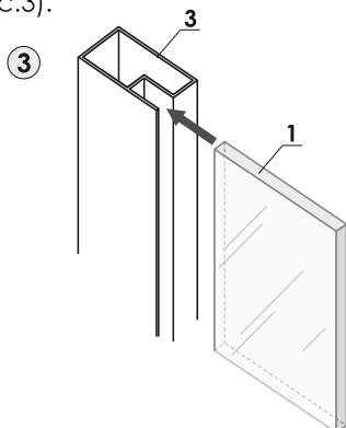
4. Второй вертикальный профиль задвиньте на свободный край стекла. Используя шурупы 4x45, соедините всю конструкцию в замкнутую рамку (рис.4).
