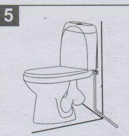
**Место установки.** Поставьте унитаз на предполагаемое место установки. Разметьте места установки крепежных болтов и определите место подсоединения выходного патрубка к системе канализации.
