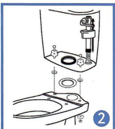
**Рис. 2:** Установите крепежные болты и прокладку согласно схеме. Затяните крепежные болты.
