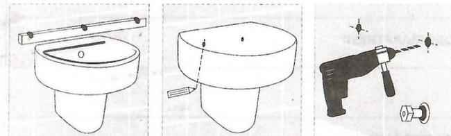
1. К приготовленной для монтажа стене, приложите умывальник, установив ее на пьедестал и выровняв его по горизонтали (использовать уровень рис 1).
