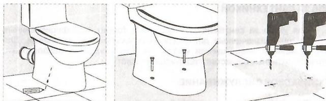
3. Просверлите и установите дюбели. Прикрутите чашу унитаза к полу, используя входящие в комплект болты. Во избежание скопления влаги под унитазом после мытья полов и повышения устойчивости рекомендуем заделать соединение основания унитаза с полом плиточным клеем или герметикам.
