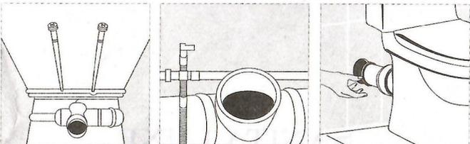
2. Соедините чашу унитаза с выходом канализации с помощью отвода, определив место его расположения. Отметьте через монтажные отверстия основания унитаза места сверления на поверхности пола под монтажные дюбели.
