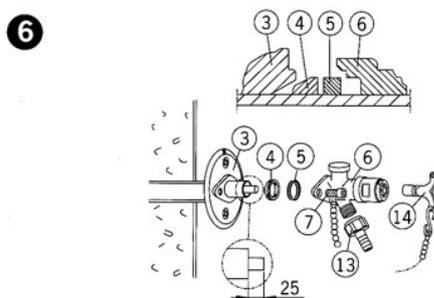
1. Просверлите в стене сквозное отверстие  $\text{Ø} 25$  мм. Чтобы предотвратить замерзание, отверстие должно иметь наклон примерно  $2^\circ$  в наружном направлении.
