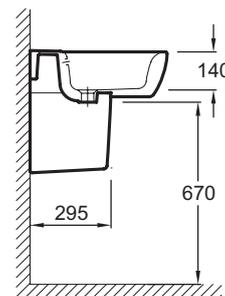
Спецификация продукта: Раковина 60 x 50 см с заглушкой для переливного отверстия. E1564. Коллекция: OVE. Размеры (см): 60 x 50 см. Вес: 16,3 кг. Материал: Керамика. Разметка сверления отверстия для смесителя: С 1 отверстием для смесителя. Дополнительная опция: Пьедестал или полупьедестал.
