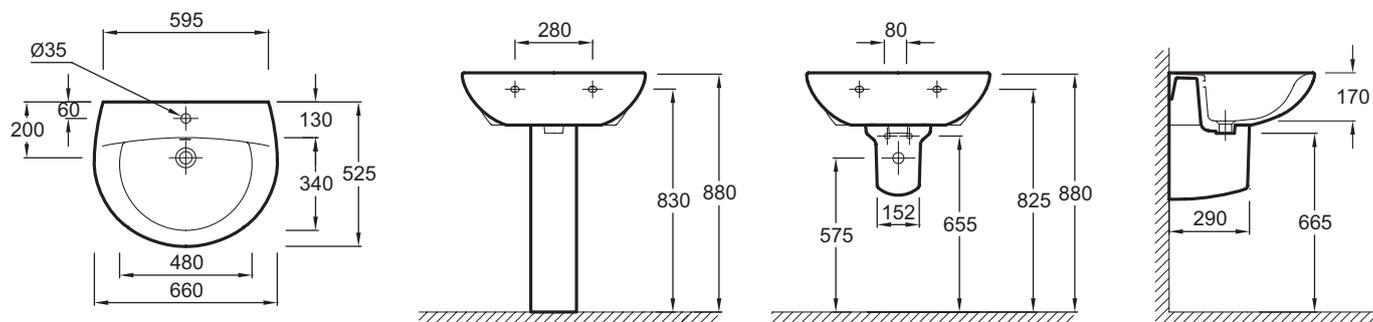
Спецификация продукта: Раковина. E1998G. Коллекция: PATIO. Вес: 17,5 кг. Разметка сверления отверстия для смесителя: С 1 отверстием для смесителя, 2 размечено.
