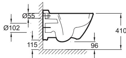
Спецификация продукта: Подвесной унитаз 55,5 x 38 см. E4440. Коллекция: PRESQU'ILE. Размеры (см): 55,50 x 38 см. Вес: 22,4 кг. Материал: Керамика. Тип установки: Подвесная. Расход воды: 2,6/4 л и 3/6 л. Высота: Регулируемая от 38 до 50 см. Тип обода: Открытый обод. В комплекте: эргономичная крышка-сиденье из термодюра E70016, металлические шарниры.
