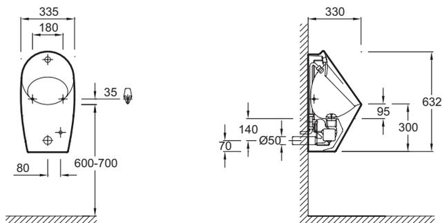
Спецификация продукта: Писсуар 33,5 x 63,2 x 30 см, с встроенной подводкой, сливной трубой. E1547. Коллекция: PATIO. Размеры (см): 30 x 62 см. Вес: 19 кг. Материал: Керамика. Высота: Стандартные. Писсуар с электронным управлением.
