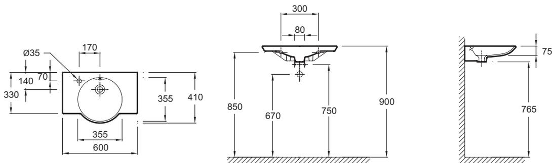
Спецификация продукта: Полуистраиваемая раковина 60 x 33/41 см. E4503. Коллекция: SPHERIK. Размеры (см): 60 x 41 см. Вес: 9,6 кг. Разметка сверления отверстия для смесителя: С 1 отверстием для смесителя слева. Дополнительная опция: полотенцесушитель (хром/черная матовая сталь).
