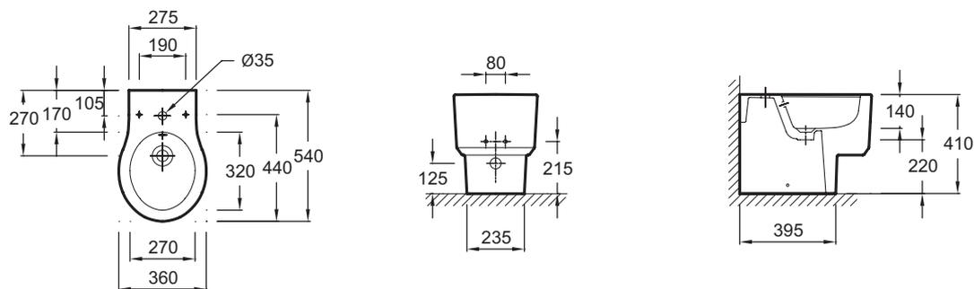
Спецификация продукта: Напольное биде 54 x 36 см. E4794. Коллекция: VIRAGIO. Размеры (см): 54 x 36 см. Вес: 22,3 кг. Материал: Керамика. Высота: Комфорт. В комплекте: крышка для биде с механизмом "плавное опускание" 4770К, металлические крепления. 1 выпускное отверстие.
