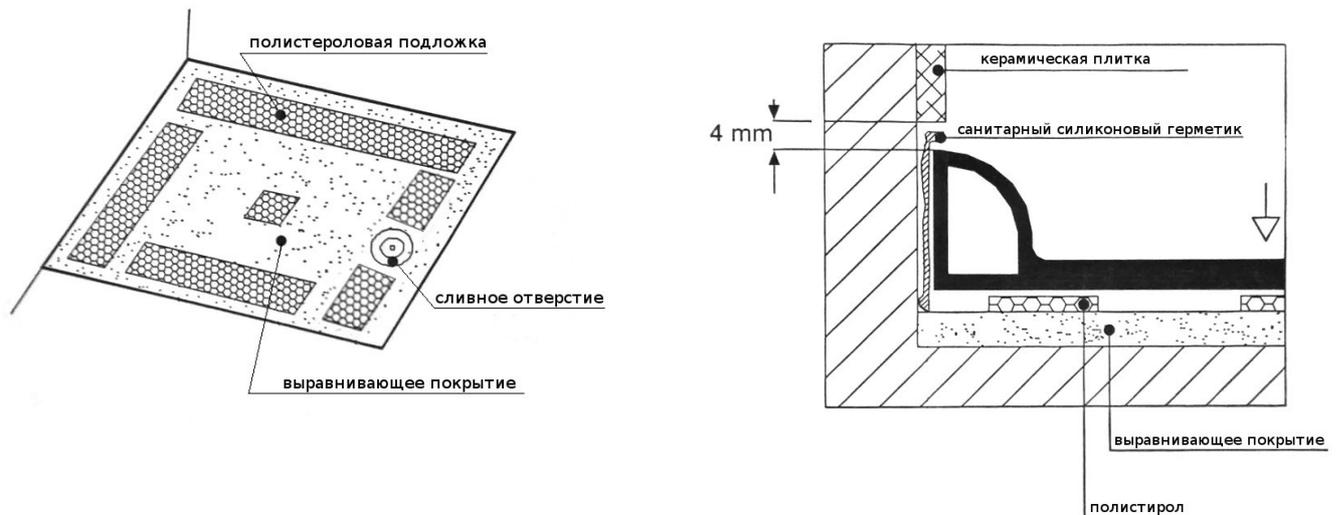
2. Положите душевой поддон в место, где он будет устанавливаться, таким образом, чтобы остался зазор 4 мм между поддоном и настенной плиткой. Убедитесь, что сливное отверстие поддона правильно легло на уплотнительную манжету сливного сифона.
