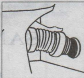
2.Соедините чашу унитаза с выходом канализации с помощью отвода, определив место его расположения. Отметьте через монтажные отверстия основания унитаза места сверления на поверхности пола под монтажные дюбеля.
