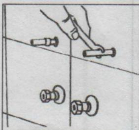
5.Соедините шланги подводки с водоподводящими трубами, а сифон с канализационной трубой. Откройте воду. Проверьте надежность - герметичность соединений и работу смесителя.
