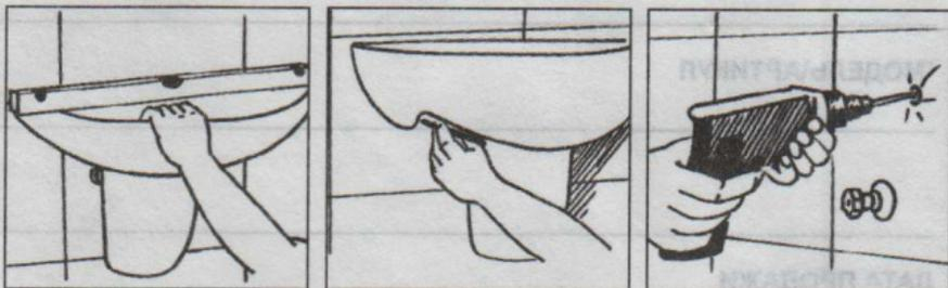
1. К подготовленной для монтажа стене, приложите умывальник, установив ее на пьедестал и выровняв его по горизонтали (использовать уровень рис 1).
