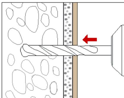
Разметьте и просверлите два отверстия  $\varnothing 10$  мм и глубиной 50 мм.
