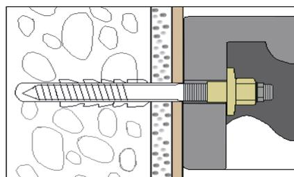
Поставьте шайбы-эксцентрики, отрегулировав горизонтальное положение раковины. Затяните гайки, наденьте декоративные колпачки.
